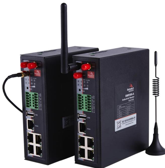
BMR500 是一款应用于物联网的工业级无线路由器，产品功能包括：数采接入、通信协议转换、5G/4G/3G 无线通信、高速路由、WIFI 覆盖、本地存储等，为苛刻的无人值守现场提供永远在线的通信网络。该产品兼容 MQTT、HJ212、JSON、MC、OPC、HTTP、TCP、UDP、Modbus RTU/ModbusTCP 等通信协议，通电即可组网，被广泛应用于远程数据采集、远程监测、远程告警、远程控制等领域。在大型设备监测、工业自动化、智慧市政、泛在电力物联网等恶劣工况场景应用优势明显。
